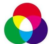
*Application :* La **synthèse additive** est mise en application dans le procédé **RVB** des écrans plats. La couleur de chaque point (ou pixel) de l'écran est obtenue en réglant l'intensité lumineuse de chaque sous-pixel (rouge, vert et bleu), trop petits pour être distingués par l'œil qui ne perçoit que la superposition des lumières colorées.
